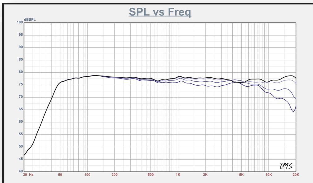
Abbildung 1: Schalldruckverlauf von 0° bis 45°
