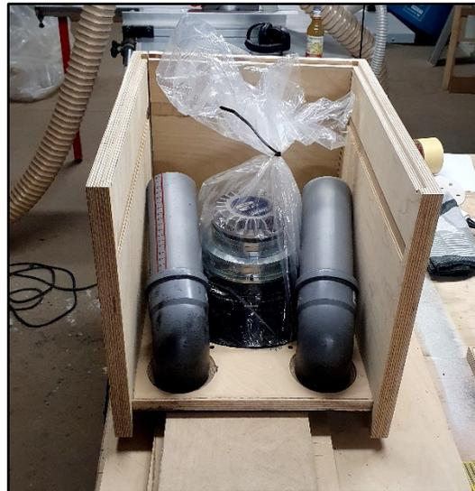
Abbildung 2: Anordnung und Position der Reflexkanäle (variable Länge; hier die längste Version der Kanäle)
